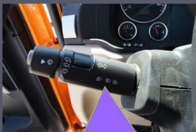
Przełącznik świateł drogowych. Włączamy do siebie. Wyłączamy od siebie.
